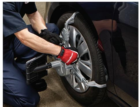
Abrazadera AC400 opcional puede sujetarse con seguridad en los neumáticos sin tocar el borde de la rueda garantizando fuerza limitada y fijación consistente.
